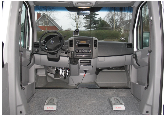
Het Dahl dockingstation op de vloer gemonteerd
