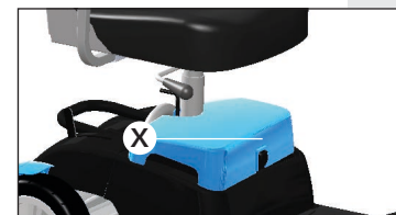
Contact chargeur batterie
