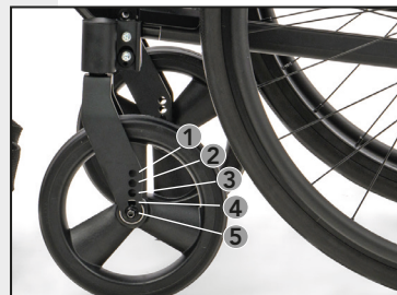
Die Positionen 1 bis 5 entsprechen der Höhenposition des Rades im Gabelkopf.
