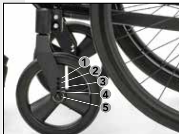
Locaties 1 t/m 5 komen overeen met de hoogtepositie van het wiel in de gaffel
