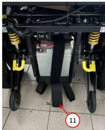
9.2 Méthodes de détachement d'un boîtier de batterie à bande Velcro fixe
