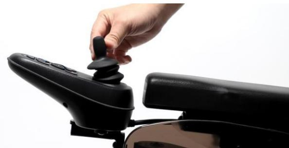
Étape 2. Poussez le joystick vers l'avant jusqu'à ce que le système de commande émette un bip.
