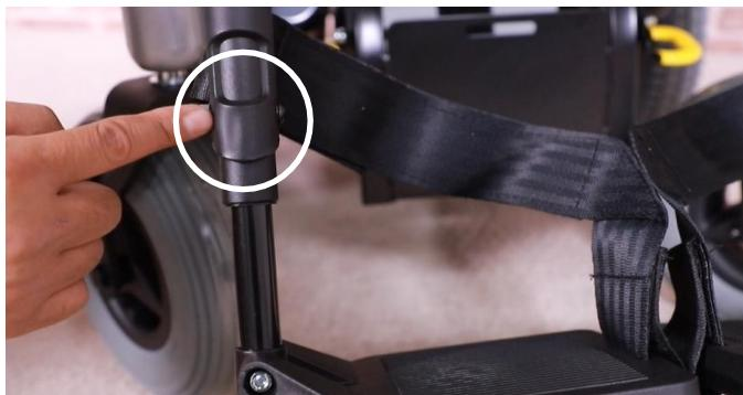
Utilisez une clé plate de 10 mm et une clé Allen de 5 mm du kit d'outils KARMA pour desserrer le boulon sur le côté du repose-pied, régler la hauteur du repose-pied et resserrer le boulon. Maintenant, les repose-pieds sont placés dans une position différente.
