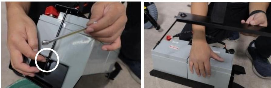
Étape 10. Utilisez une clé ouverte de 8 mm pour desserrer ce boulon.
