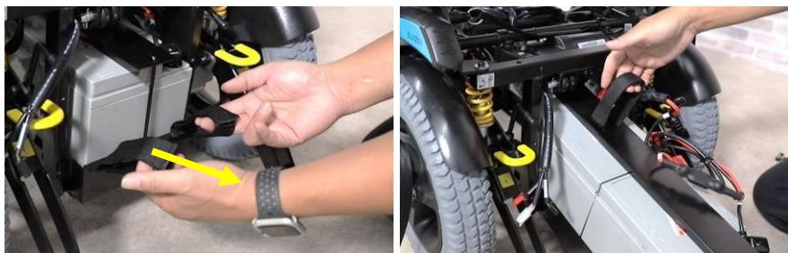
Étape 9. Utilisez la sangle arrière et avant pour retirer la plaque de la batterie
