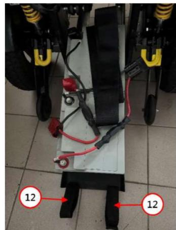
Étape 9.2.2 Utilisez les deux sangles (12) du boîtier de batterie pour retirer l'ensemble du boîtier de batterie.
