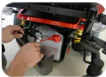
*Position de la batterie arrière (derrière les deux couvercles)*
