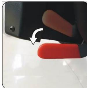
Mode de conduite : Tournez les deux leviers vers le haut jusqu'à la position la plus haute. Le fauteuil roulant peut être entraîné par la puissance du moteur. Assurez-vous que le levier est en mode de conduite.
