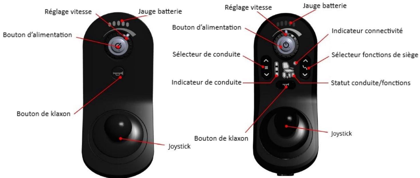
*Panneau de commande avec fonctions électriques / Panneau de commande sans fonctions électriques*
