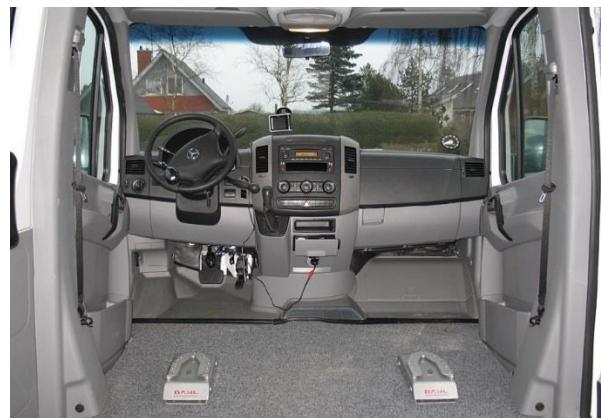
*Station d'accueil Dahl montée sur le plancher du véhicule*
