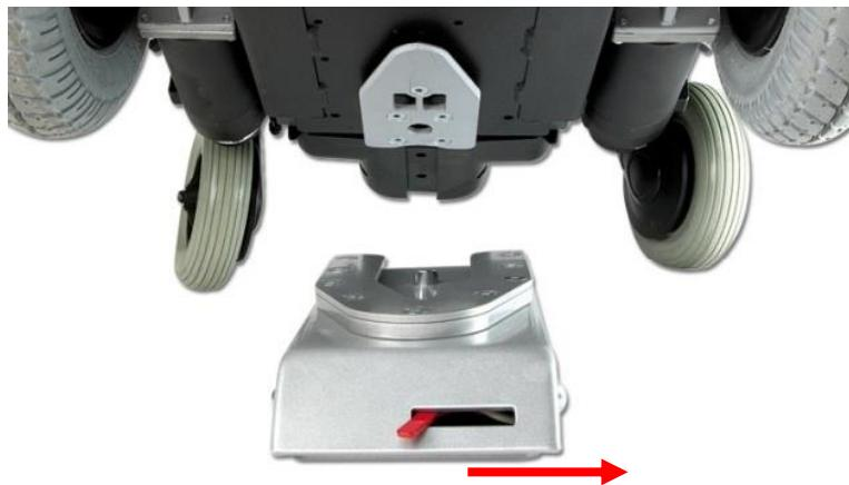
Pour déverrouiller manuellement la station d'accueil, le levier rouge doit être tiré vers la droite. Cela rétracte manuellement le boulon de verrouillage afin que le fauteuil roulant puisse être libéré de la station d'accueil.
