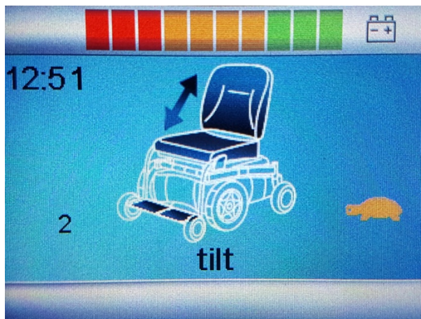
Écran d'inclinaison du siège dans le menu
