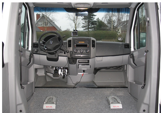
Station d'arrimage Dahl montée sur le sol
