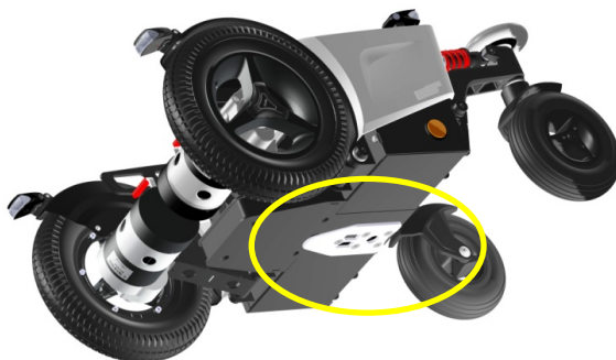
Châssis EvO munit d'une plaque d'arrimage Dahl.
