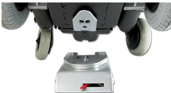
Station d'arrimage et plaque d'arrimage sur le châssis
