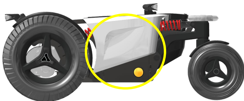
Compartiment des batteries
