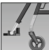
T2-E: 3 gaten zichtbaar
