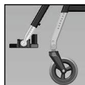
T2-I: 7 Löcher sichtbar
