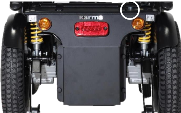
Position des Leistungsschalters
