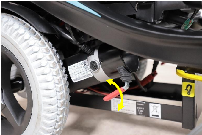
Prüfung der Bremsentriegelung
