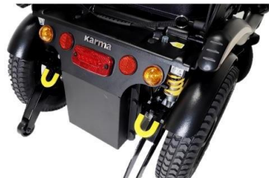
Lüftungsschleifen im Heck
