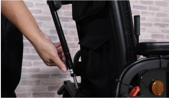
Drücken Sie den Neigungshebel am Hebesitz
