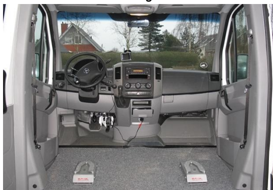
Dahl Dockingstation auf dem Boden montiert
