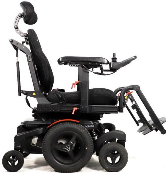
Empfohlene Position der Rückenlehne, Beinstütze und Kopfstütze
