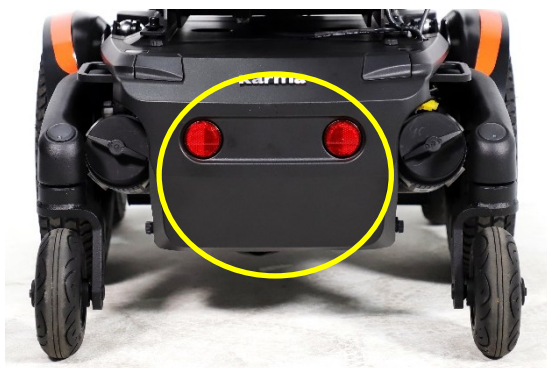
Position der hinteren wartungsfreien Batterien
