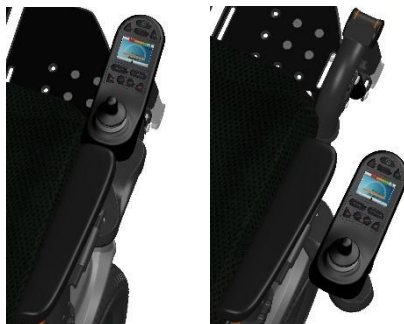
Joystick mit Halterung, schwenkbar
