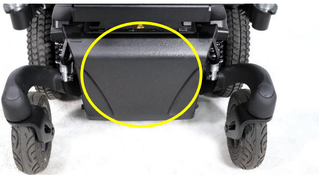
Position der vorderen wartungsfreien Batterien
