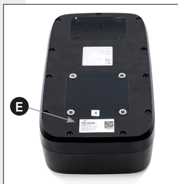
Systeembox (iBox) met aanduiding Serienummersticker
