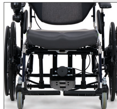
Systeembox (iBox) op de Canto Nxt
